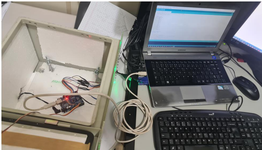
Figura 9: Imagem fotográfica da conexão Arduino ao computador via cabo USB, o computador é só usado para fazer modificações no programa do Arduino.
