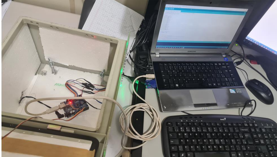
Figura 15: Imagem fotográfica da conexão Arduino ao computador via cabo USB, o computador é só usado para fazer modificações no programa do Arduino.
